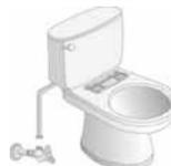
10. Legen Sie einen Dichtungsring in die Überwurfmutter des T-Stücks (Seite 5, Pos. 7) ein. Verschrauben Sie das T-Stück mit dem Wasseranschluss. Achten Sie auf die Ausrichtung der Abgänge.
